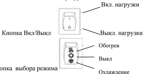
\* **ТН-0343-не имеет выключателя нагрузки**
