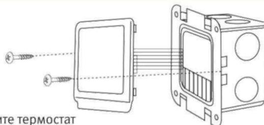
Установите термостат в монтажную коробку, закрепив шурупами
